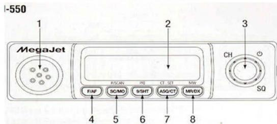
1. Разъем для подключения внешнего микрофона
