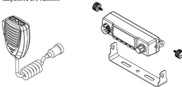
**Установка микрофона с контроллером (модель MJ 555)**
